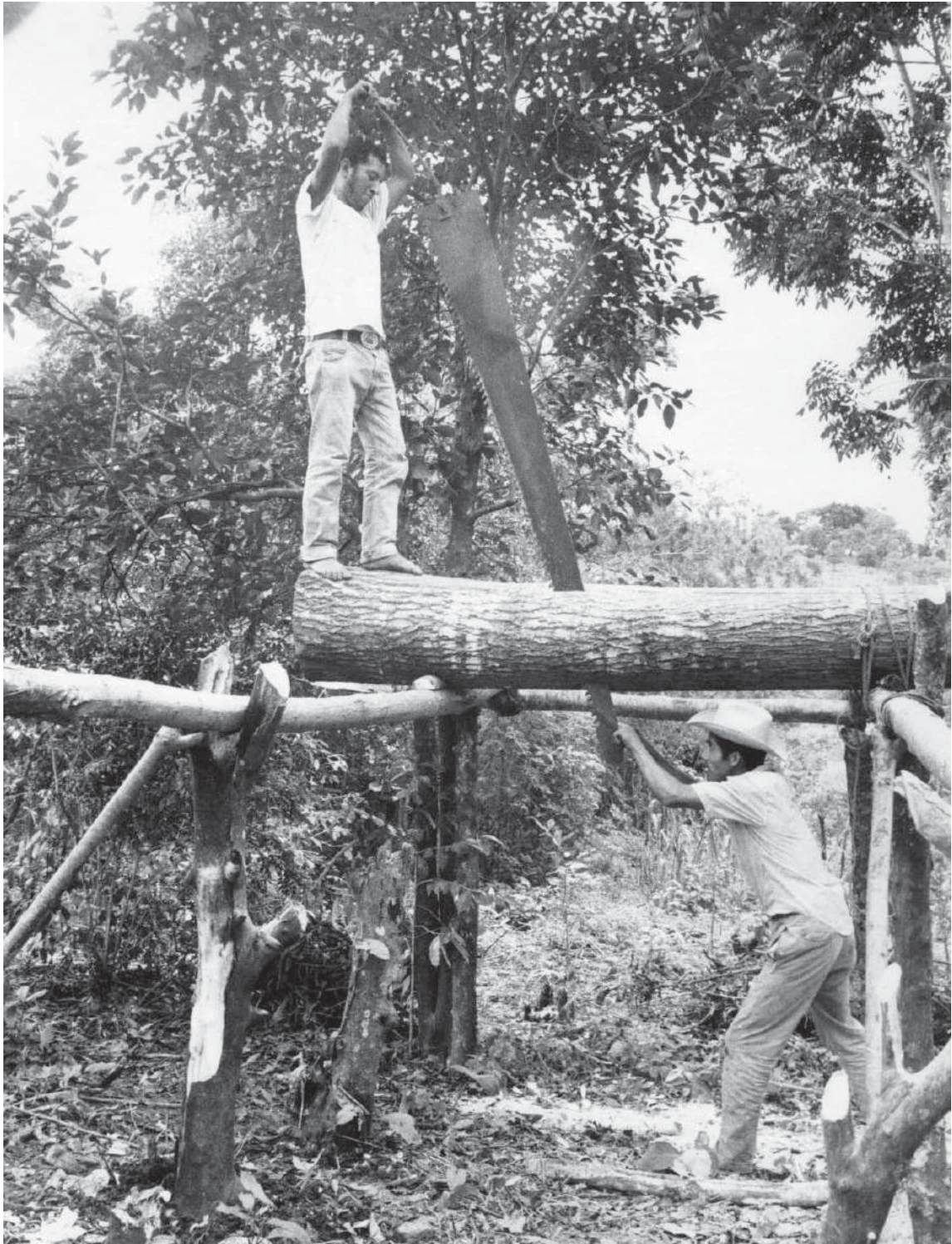
Para serruchar el tronco eso está levantado y amarrado sobre una construcción de palos.
