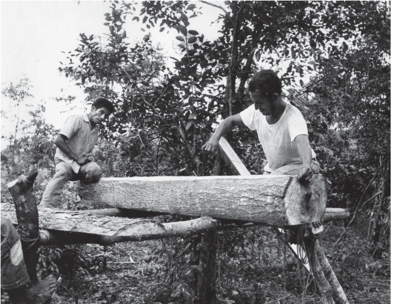
Con un hilo saturado de pintura se marcan las líneas en el tronco donde van a serruchar.
