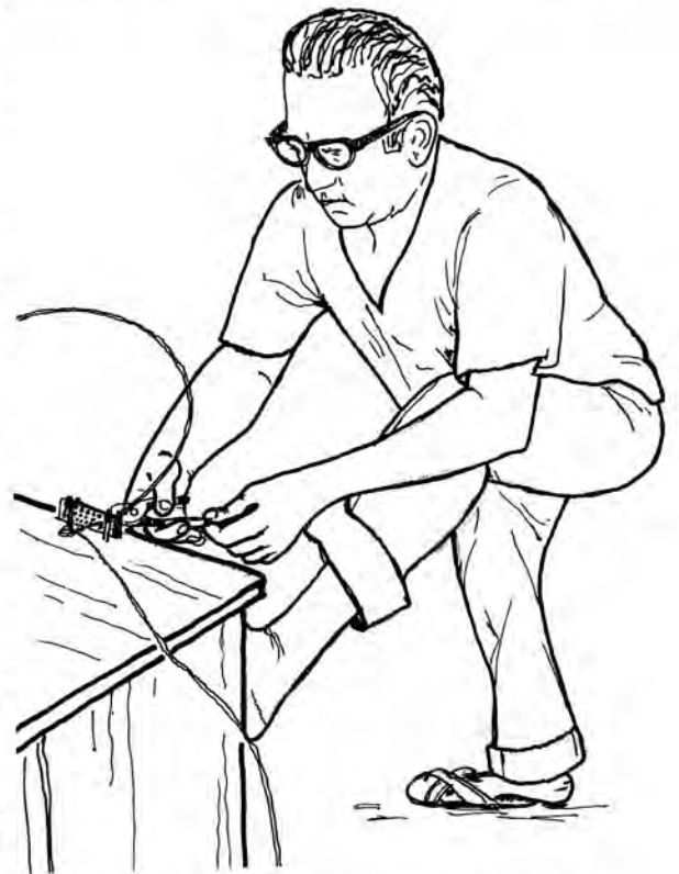
El platero utiliza diversas hileras para adelgazar el hilo de oro o plata.
